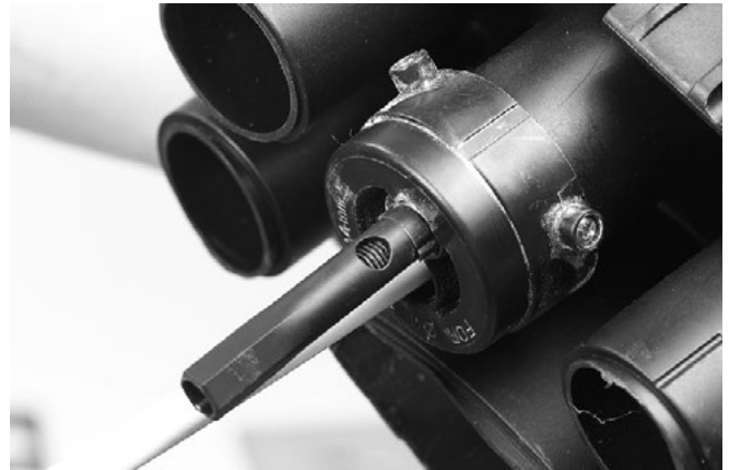
4.7.10 Spänn skruven för hand tills flänsarna låser. Fjädern skall ej synas.
